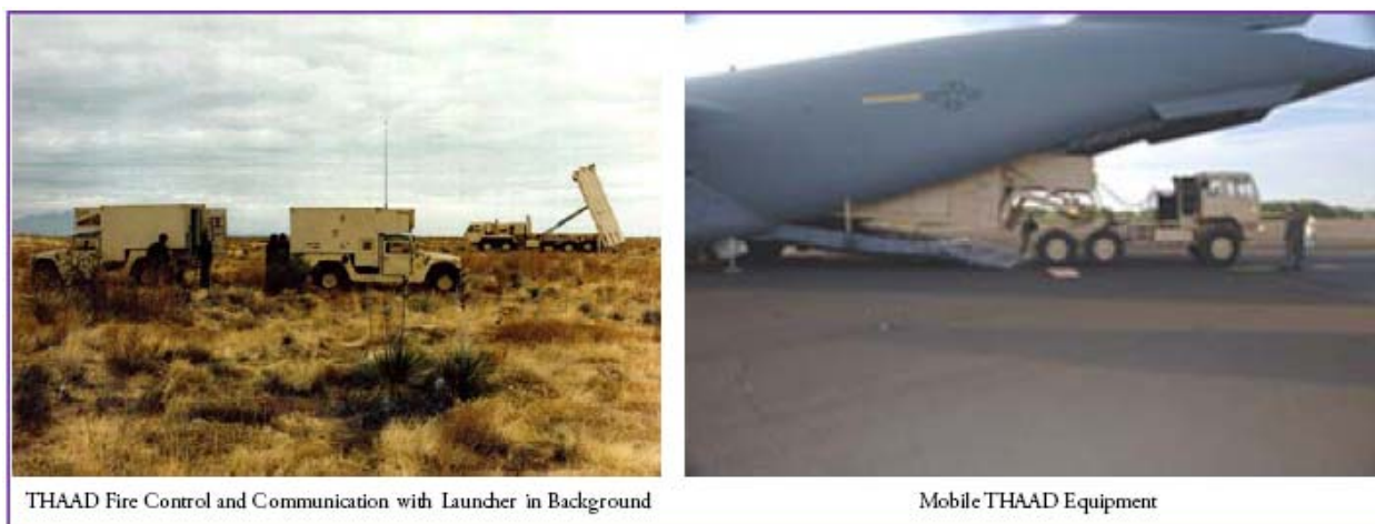
ЭЛЕМЕНТЫ ПРК ТХААД. Данный комплекс используется для защиты площадей от ракет малой и средней дальности на конечном участке траектории их полета
