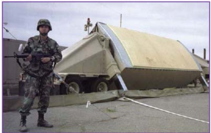
РЛС AN/TPY-2. Эта транспортабельная радиолокационная станция 3-см диапазона развертывается в Японии для обнаружения и сопровождения ракет в районе Тихого океана
