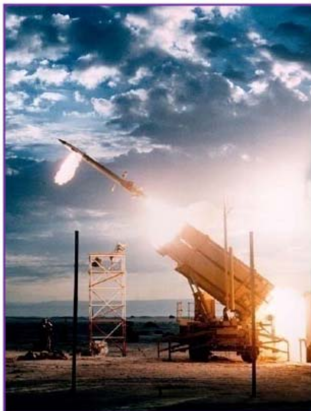
ПУСК ПРОТИВОРАКЕТЫ ПАК-3. Комплекс «Патриот», оснащенный этой противоракетой, способен перехватывать ракеты малой и средней дальности в конце траектории их полета на относительно небольших дальностях
